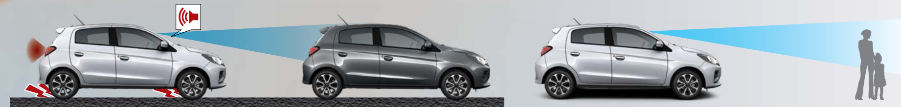
בלימה אוטונומית של הרכב במצב חירום Forward Collision Mitigation - FCM
